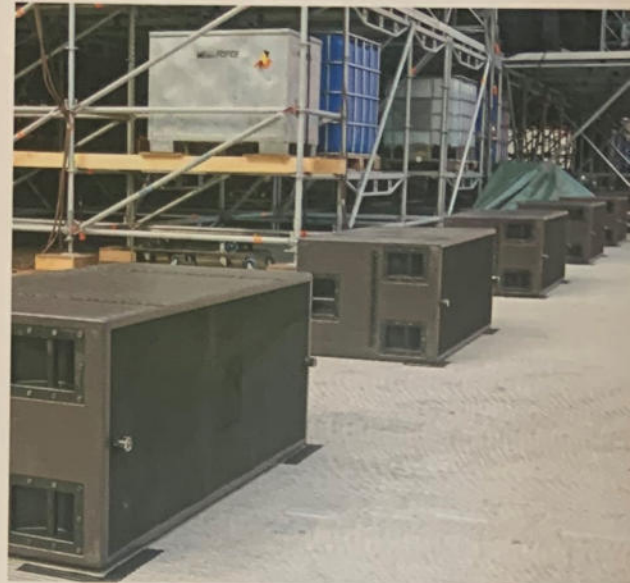
Für eine kraftvolle Wiedergabe der tiefen Frequenzen sorgten 16 liegende SB218-Subbässe, die sich in gleichmäßigen Intervallen vor der Bühne verteilen.
